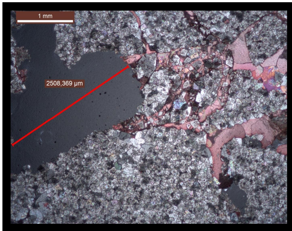
Fig. 1. Dolomia masiva en la que apreciamos cristales de calcita, bien previos, bien de nueva formación. Espacios abiertos de gran tamaño como puede verse en la imagen.
